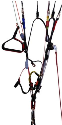
Poulie en position médiane : aimant EK magnet placé au dessus de la boucle de trims
