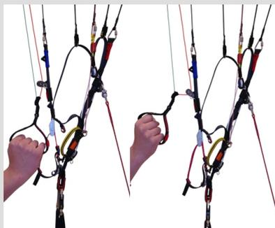
**Freinage avec poignées de frein principales seulement (vol rapide ou lent) :** l'effet dépend de la direction dans laquelle on tire les freins (détails p.suivante)
