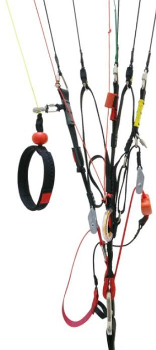
**Figure 4** Ligne TEA inactive (a) et engagée (b)
