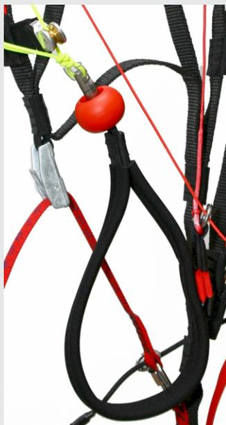
L'Easy Keeper est notre système innovateur de fixation des poignées de frein aux élévateurs. Des aimants en néodyme solides et fiables arriment les poignées et permettent de les déplacer facilement. Grâce à cela vous pouvez aisément sécuriser les freins pendant le vol, réduisant le danger de les mettre en contact avec l'hélice.
