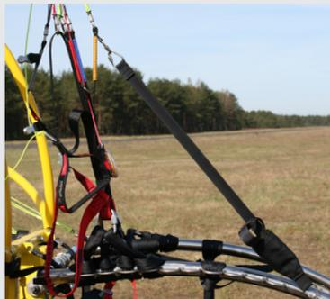
Des sangles additionnelles raccourcissent les éleveurs A au cours du gonflage (à gauche). Quand la voile est positionnée, les A reprennent leur longueur d 'origine (le système d 'assistance cesse de fonctionner (à droite).
