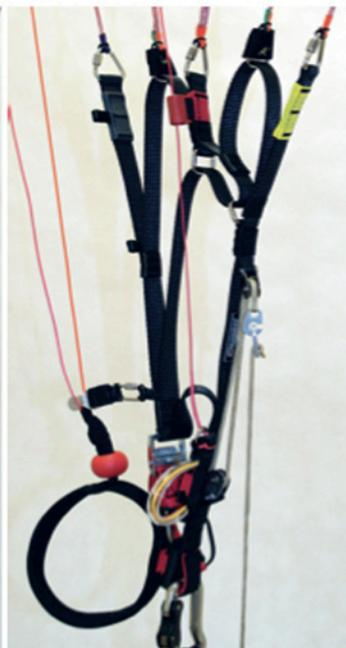
Poulie en 3e position, trims fermés ; l'aimant EK est fixé au dessus du mousqueton.
