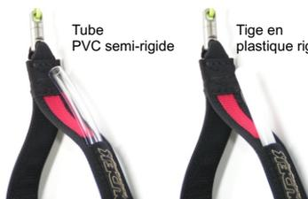
La poignée est la plus souple lorsqu'elle ne contient aucune insertion.
