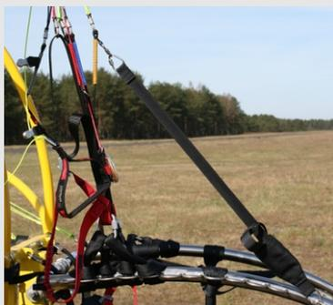
Des sangles additionnelles raccourcissent les élévateurs A au cours du gonflage (à gauche). Quand la voile est positionnée, les A reprennent leur longueur d'origine. Photo de droite : le système d'assistance cesse de fonctionner.
