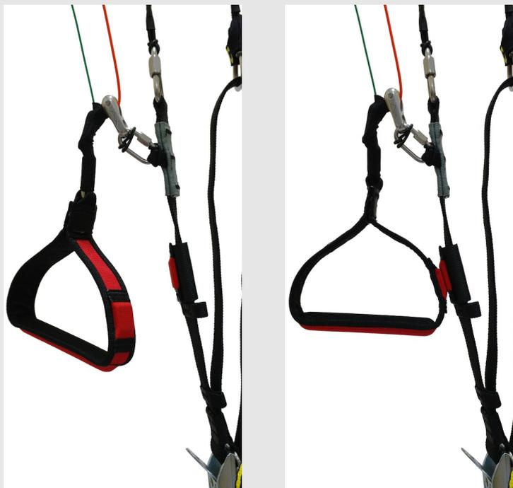
L'Easy Keeper est notre système innovateur de fixation des poignées de frein aux élévateurs. Des aimants en néodyme solides et fiables arriment les poignées et permettent de les déplacer facilement. Grâce à cela vous pouvez aisément sécuriser les freins pendant le vol, réduisant le danger de les mettre en contact avec l'hélice.
